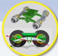
Система Roll-Over для упрощения тяги в тяжелых условиях
